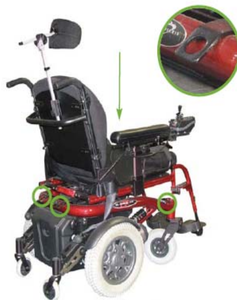
quatre (4) points d'ancrage
